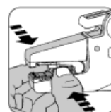
Tope regulable, presionar por ambos lados
